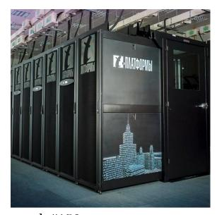
rank #156 1696 nodes with: 1× Intel Xeon E5-2697 v3 1× NVIDIA Tesla K40M 1× InfiniBand FDR
